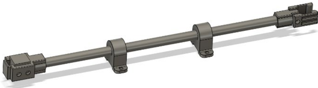
Abbildung 4: Screenshot des CAD-Files vom Versuchsaufbau zum Messen der Betätigungsmomente
