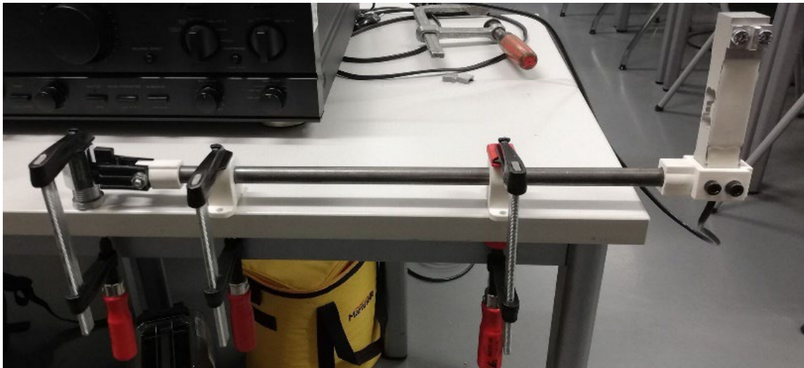
Abbildung 5: Realer Versuchsaufbau zum Messen der Betätigungsmomente
