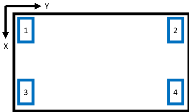
Abbildung 6.1 Position und Index der Wägezellen unter dem Abtropfblech
