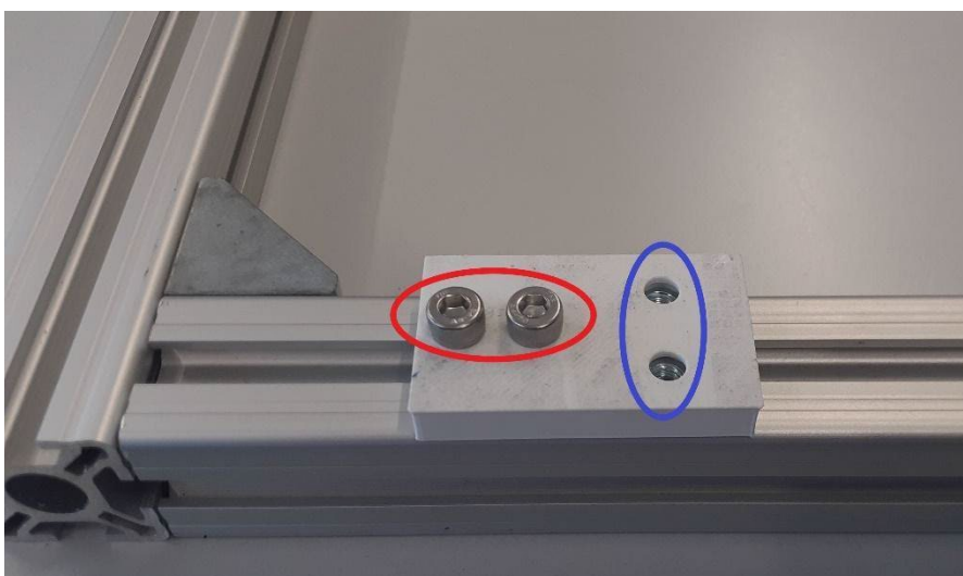
Abbildung 5.3 Verbindungsteil zwischen Rahmen und Wägezellen für Konzept 2
