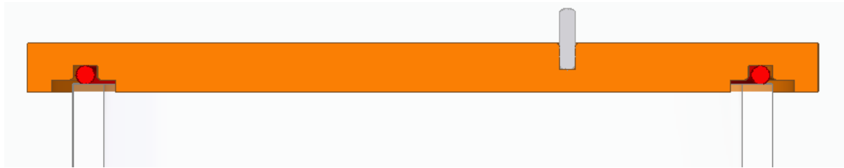
Abbildung 4: Aktuelle Deckelkonstruktion mit O-Ring und innerem Glaszylinder
