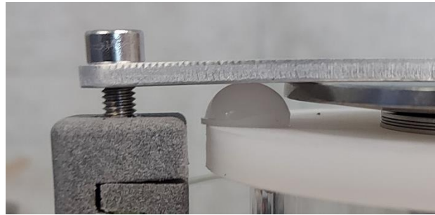
Abbildung 52: Positionierung der Anschlagpuffer auf dem Boilerdeckel
