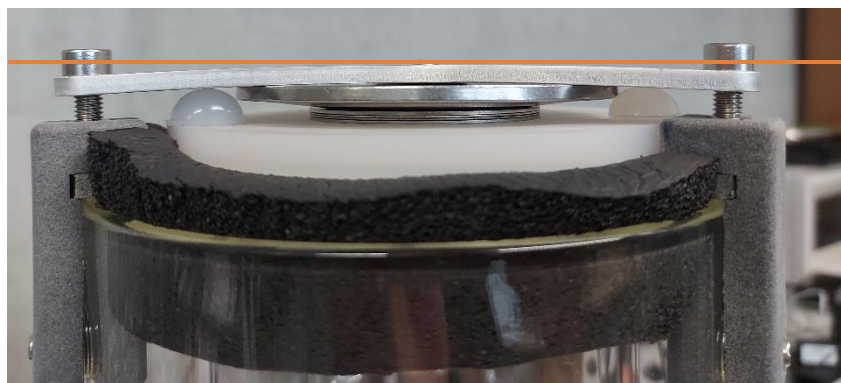
Abbildung 53: Durchbiegung des Verspanndeckels
