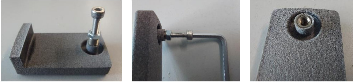
Abbildung 35: Montageprozess des M3-Gewindeeinsatzes
