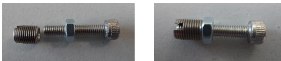
Abbildung 34: Improvisiertes Werkzeug zur Montage der Gewindeeinsätze
