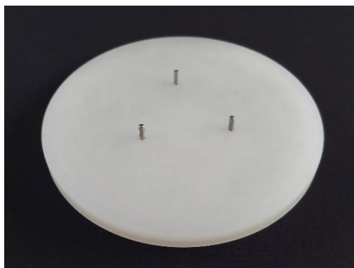
Abbildung 42: Boilerdeckel mit montierten Zylinderstiften 2,5\text{mm} \times 10\text{mm}
