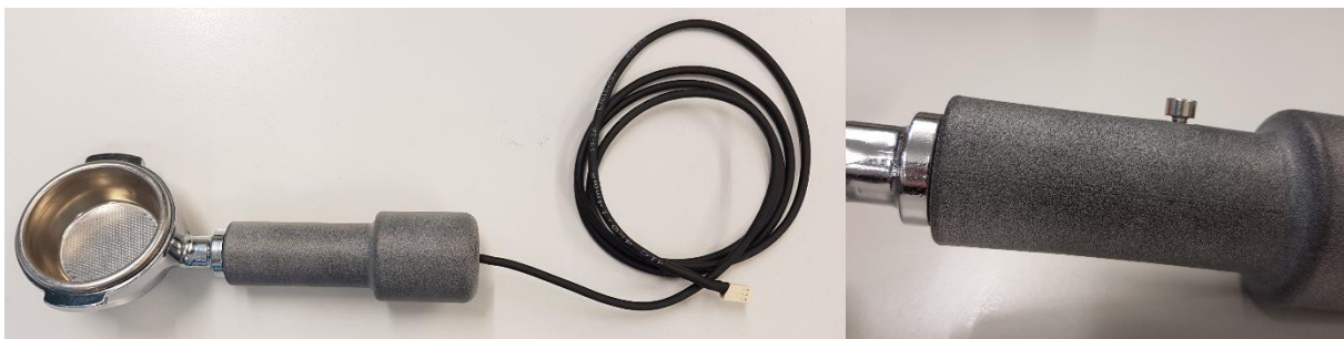
Abbildung 10: Messsiebträger mit Temperaturschutzgriff und Verkabelung (links), Schraube zur axialen Befestigung (rechts)
