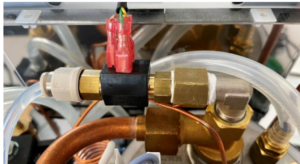
Abbildung 32: Integration des Durchflusssensors in das Messsystem
