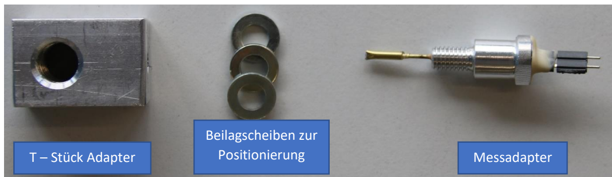
Abbildung 7: Aufbau des T – Adapters
