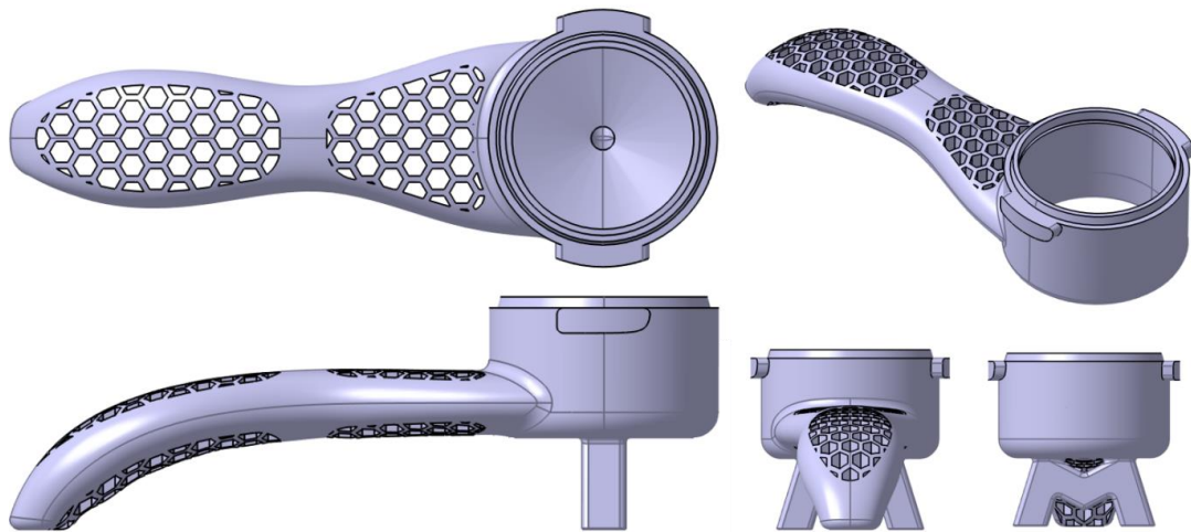
Abbildung 16: Fertige CAD Konstruktion - Version mit Auslauf und Bodenlos
