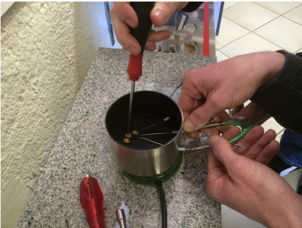
Abbildung 22: Messaufbau zur Messreihe Konduktion; Herdplatte mit Pfanne, bestückt mit Kaffeebohnen und angeschlossenen Thermoelementen
