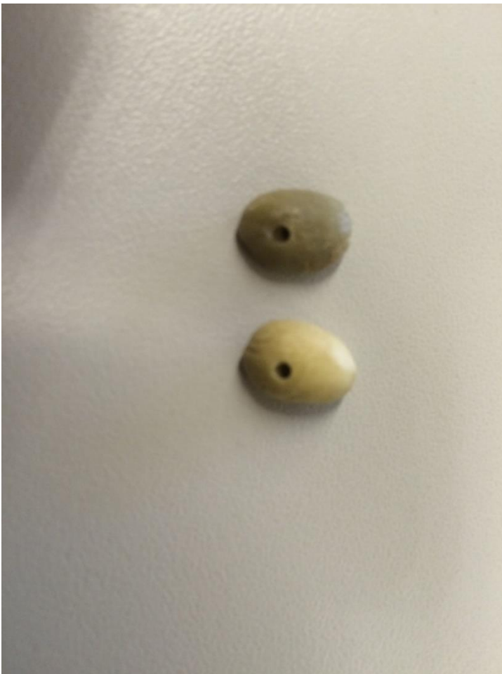
Abbildung 20: Mittels Bohrmaschine und Spiralbohrer präparierte Kaffeebohnen; Bohrung ermöglicht einführen eines Thermoelementes
