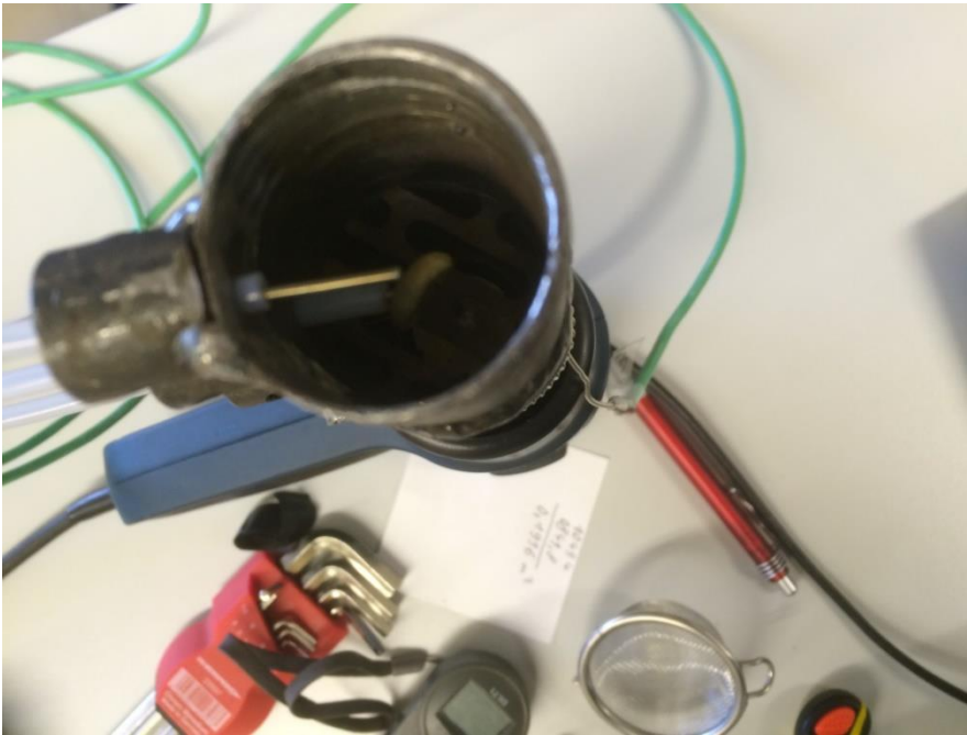
Abbildung 19: vermeintlich verbesserter Versuchsabbau durch eine am Thermoelement befestigte Kaffeebohne
