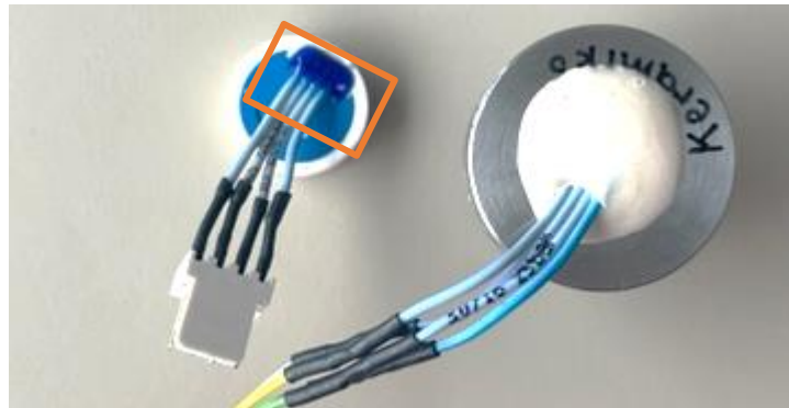
Abbildung 27: Verstärkung der Kontaktstelle
