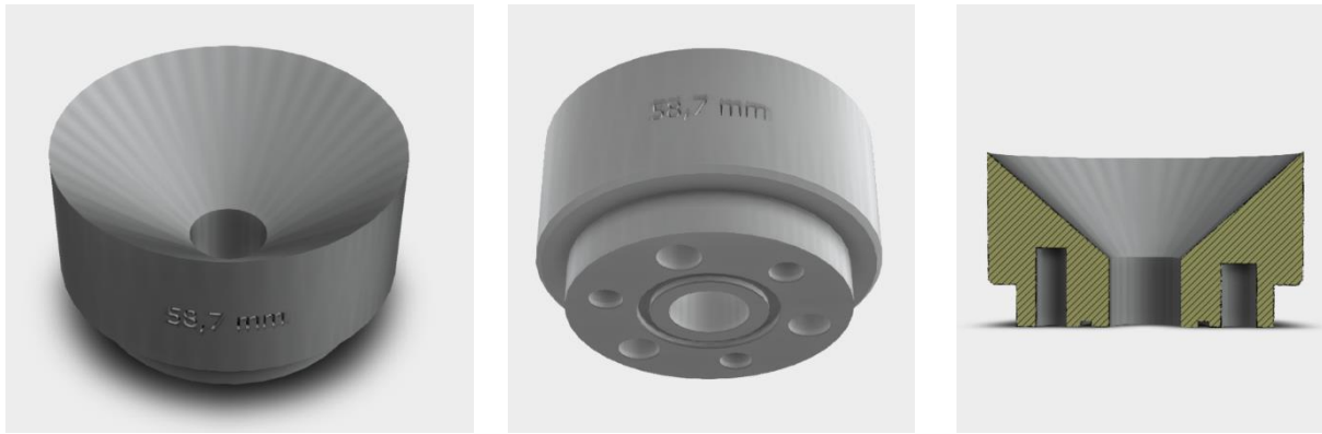
Abbildung 4: Kunststoffeinsetz für die Gaggia TE
