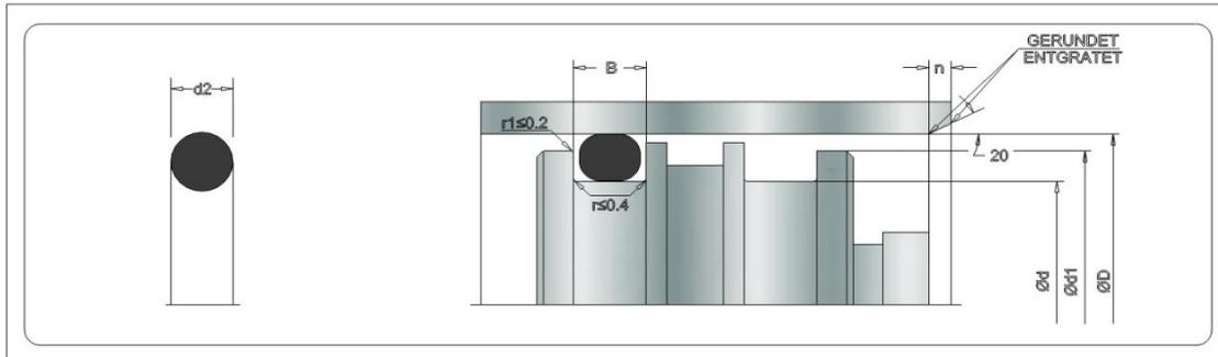
Axial, statischer Einbau (Flanschdichtung):
