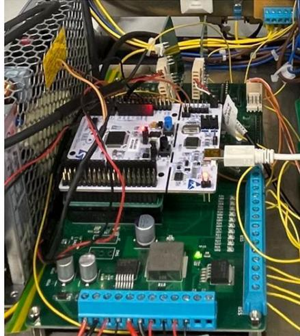
Abbildung 13: Basisplatine mit der STM32
