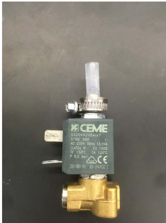
Abbildung 27: Verbautes 3/2 Wegeventil mit fehleranfälligem Schlauchanschluss
