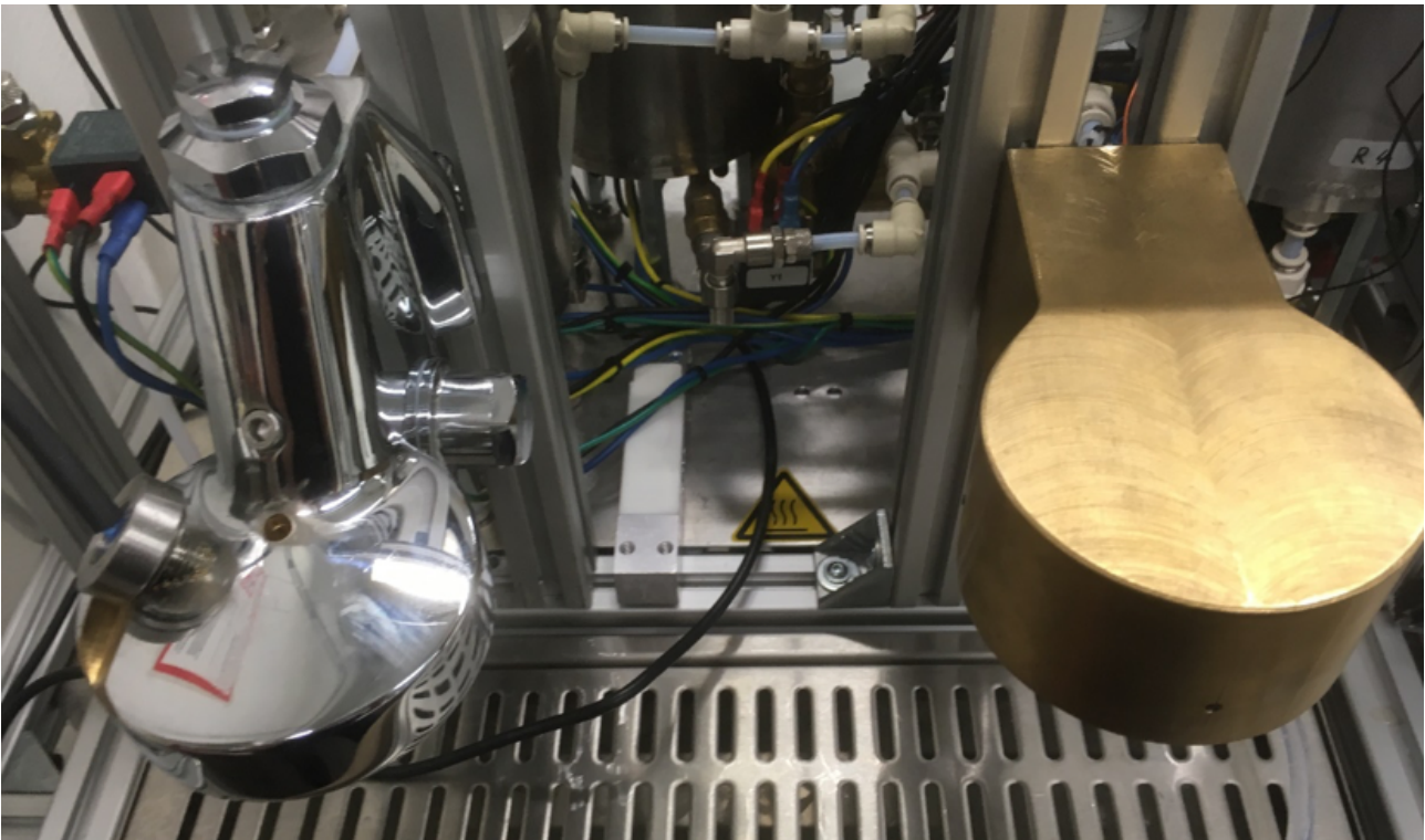
Abbildung 24: Gehäuse, Klassische E61 (Links) Gehäuse aktuell (Rechts)
