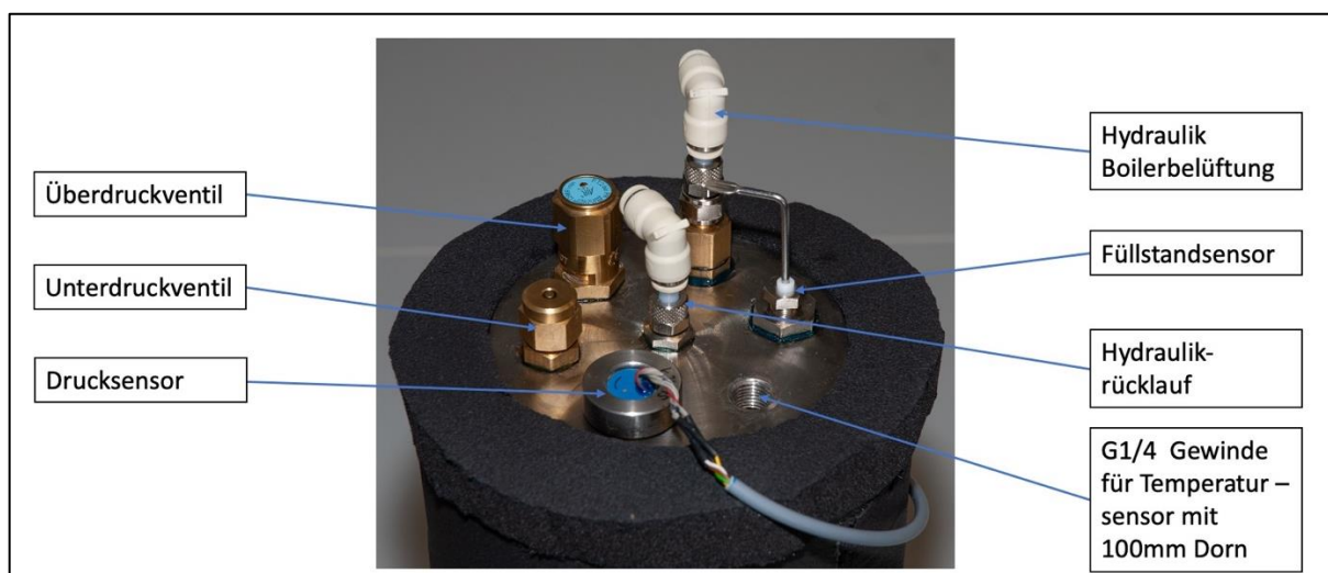
Abbildung 8: Boileranschlüsse Oberseite
